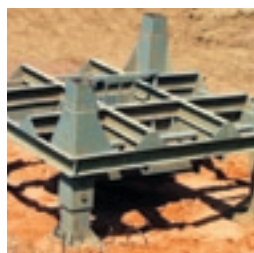
Испытание взрывоустойчивой панели от компании Von Roll взрывной волной (8 кг в тротиловом эквиваленте)
