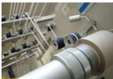
Современный перемоточно-разрезной станок для изготовления бобин с крестовой намоткой
