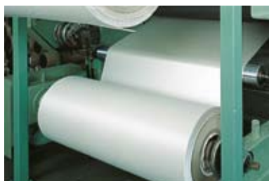
Ламинирующий станок для производства лент Cablosam®
