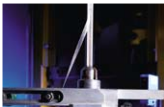
Отсутствие деформации, прогиба провода в ходе намотки
