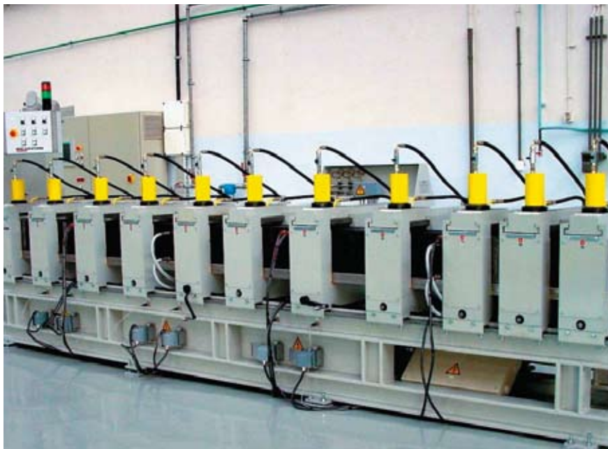
Пресс для обмоточных стержней, изготавливаемых по RR-технологии
