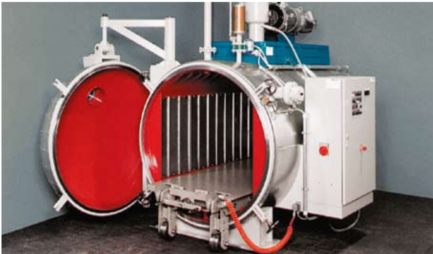
Машина для процесса пропитки по технологии VPI
