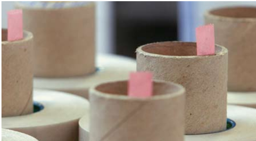
Слюдяные ленты, предназначенные для использования в VPI-технологиях
