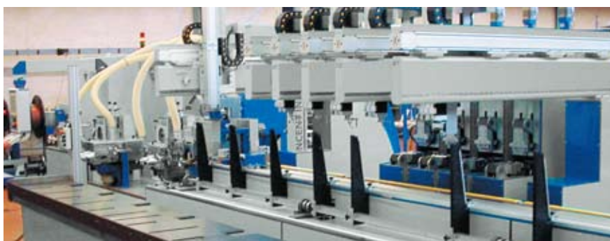
Станок для производства транспонированных стержней для генераторов большой мощности
