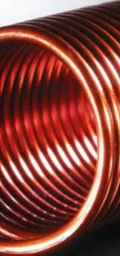
Thermex® 200 | 200°C                | Эмалированный провод с базовым покрытием из модифицированного полиэфиримида и внешним слоем из полиамидимида.                  | <ul style="list-style-type: none"> <li>— Превосходные тепловые и химические свойства.</li> <li>— Подходит для изготовления обмоток, которые подвержены постоянному воздействию высоких температур и механических нагрузок.</li> <li>— Подходит для использования на высокоскоростных</li> </ul> |
